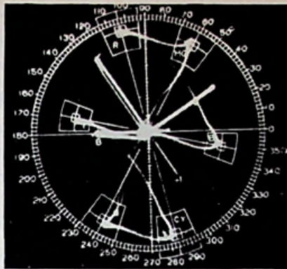
Fig. 21b. Het samengestelde kleurbalkentoetsingssignaal op het beeldscherm.
